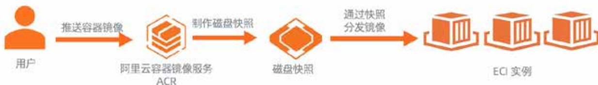
( 图为基于镜像快照的分发流程示意 )
